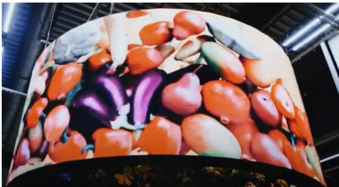
1.4 - сурет – Шеңберге бекітілген тікбұрышты матрицалардан жиналған цилиндрлік дисплей
