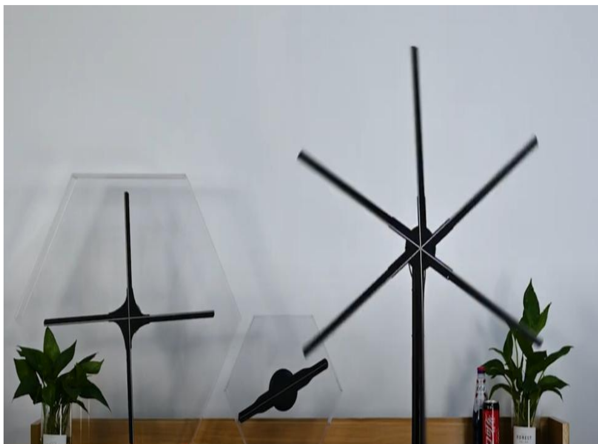
1.2 - сурет – 2, 4, 6 қалақтары бар голографиялық вентилятор
